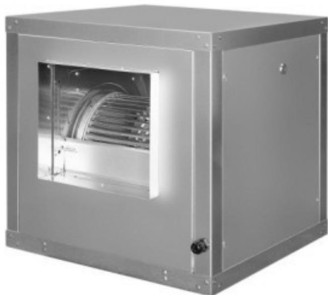
Ce ventilateur caisson 12/12 est idéal pour les professionnels de la restauration et des collectivités. Avec une puissance de 1100W, il offre une capacité de 6000 m<sup>3</sup>/h pour assurer une ventilation efficace. Grâce à ses dimensions compactes (640x620x675 mm) et son poids de 30 kg, il peut être facilement intégré dans n'importe quel espace de cuisine professionnelle.
