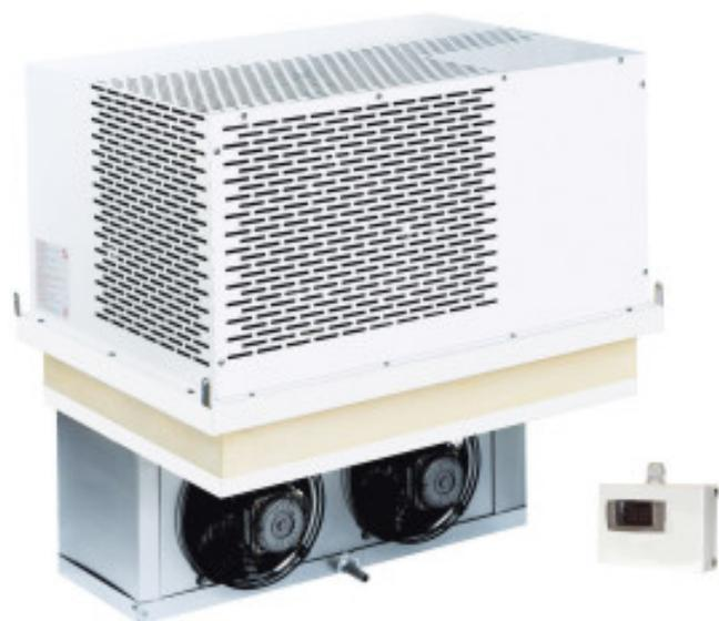
Unité de Refroidissement Négatif Plafonnier pour Chambre Froide adaptée aux volumes de 4,8 à 7 m<sup>3</sup>. Alimentée en 230V, cette unité offre une puissance de 1460W pour maintenir des températures négatives jusqu'à -25°C. Le liquide de refroidissement R452a assure un fonctionnement efficace, idéal pour conserver les produits frais dans un environnement professionnel de restauration ou de collectivité.
